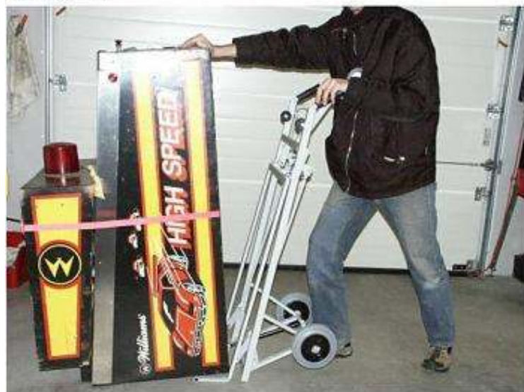
Flipper nach vorne drücken und Transportwagen drunter fahren.
