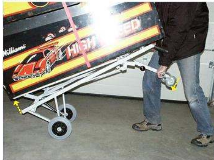
Jetzt mit der Hand den Hebel Nr.1 nach unten drücken, der Flipper hebt sich dabei hinten hoch.
