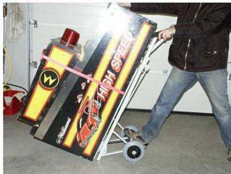
Fuß gegen die Achse stellen und den Flipper an sich ziehen. (wie bei einer Sackkarre)
