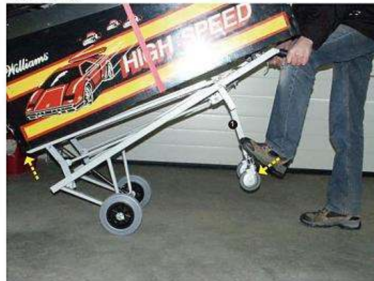
Achtung !! der Hebel Nr.1 mit den zwei Rollen muss einrasten wenn er ganz unten ist.
