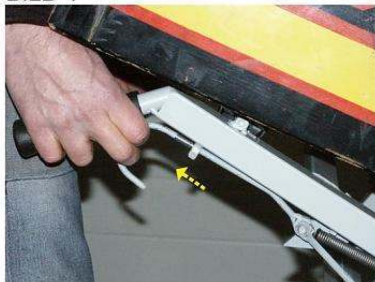
Zum Aufstellen des Flipper den Hebel nach hinten ziehen. (Entriegelt den Hebemechanismus)
