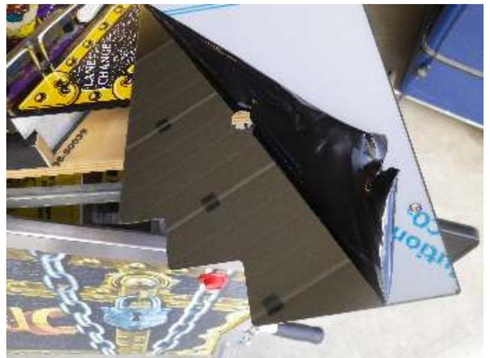
3. Schutzfolie bis zur Bohrung vorsichtig abziehen
