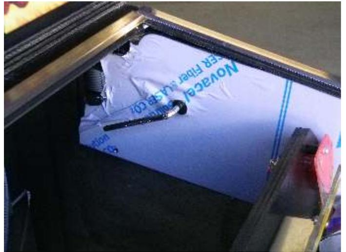
7. Blech hinten ausrichten und die große Schraube anziehen
