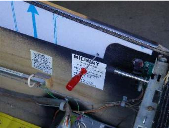
6. Spiegelblech vorne mit einem spitzem Schraubenzieher justieren (Erleichtert nachher das eindrehen der Schraube ohne das Blech zu verschieben)
