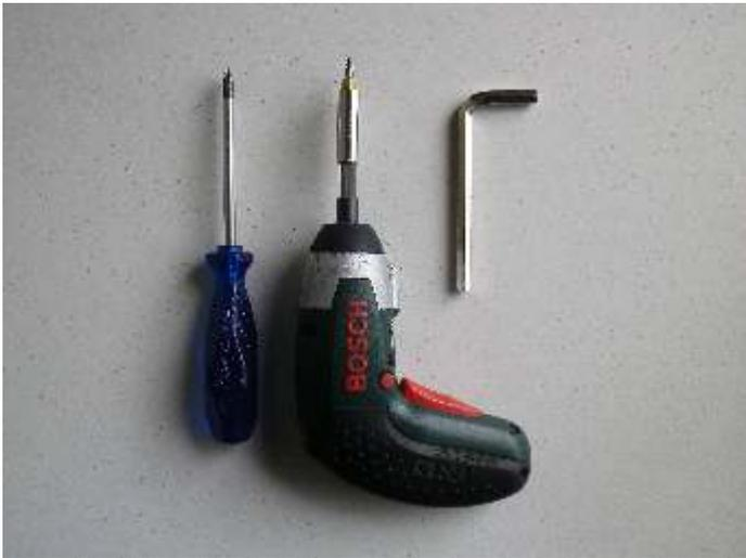
Benötigtes Werkzeug: Kreuzschraubenzieher oder Akkuschrauber und 1/4 Inbusschlüssel (6 mm geht auch)
